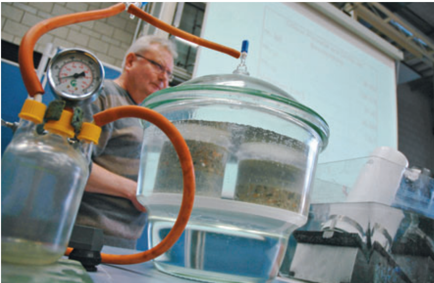
Abb. 5: Versuchs-Exponat zum Anfassen während des Praxisblocks: Bestimmung der offenen Porosität von Bohrkernen mit einem Exsikkator.
